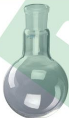
Ballons à fond rond et col rodé en verre borosilicaté
